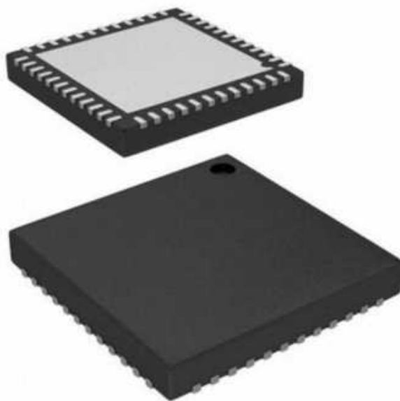
图 19 芯片封装 (VQFN-48, 7mm x 7mm)
